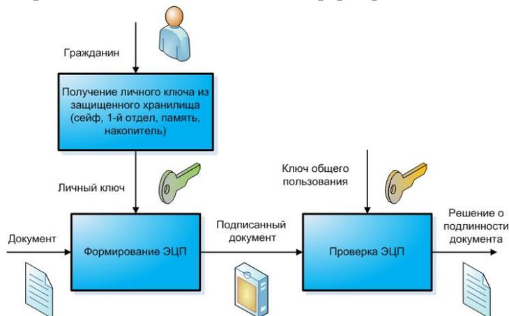
**Рис.3.** Классическая схема применения электронно-цифровой подписи
