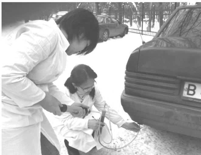
1, 3 – шланги силиконовые; 2 – адсорбер с насадкой из колец Рашига и слоев шунгита 2-х видов; 4 – индикаторная трубка-газоопределитель; 5 – насос-пробоотборник (аспиратор)
