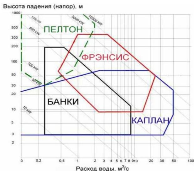
Рис. 7. Область применения гидротурбин
